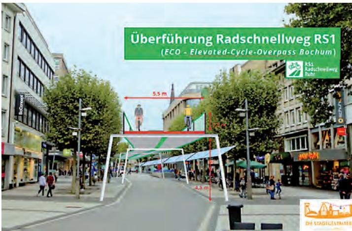
geführt werden. Die Rampe zur Radbrücke beginnt unterhalb der Eisenbahnbrücke der Glück-auf-Bahn, die über die Alleestraße führt. Westring, Hans-Böckler-Straße, Kortumstraße und Ostring werden kreuzungsfrei überquert. Vorbild für die Konstruktion ist eine Entwicklung von ThyssenKrupp Steel, die in ihrem InnoCity Konzept eine Art Baukasten für
