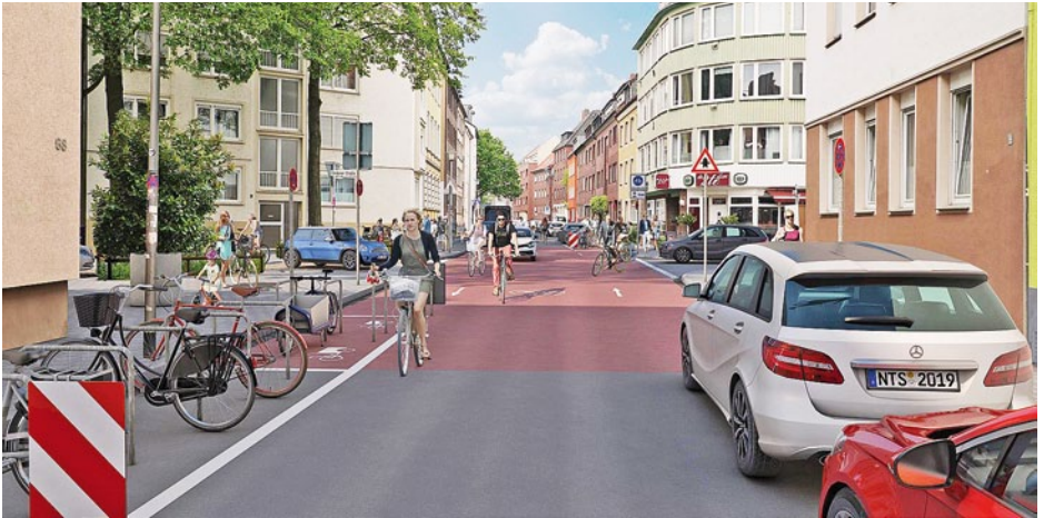
Knotenpunkt einer Fahrradstraße am Beispiel der Visualisierung für die Schillerstraße in Münster. Soll bessere Sichtbedingungen für Radfahrer und Fußgänger und Raum für Fahrradabstellanlagen bieten (Rendering: © nts Ingenieurbüro)
